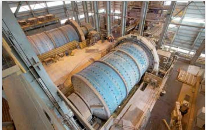
L'extension du concasseur de Morenci en Arizona a été entamée en mai 2014. Dans le cadre du projet, des concasseurs à boulet à haut rendement et un broyeur à cylindre hydraulique ont été installés permettant de traiter des volumes plus élevés de minerai avec jusqu'à 25% d'efficacité énergétique en plus par rapport aux autres circuits de broyage dans l'industrie.
