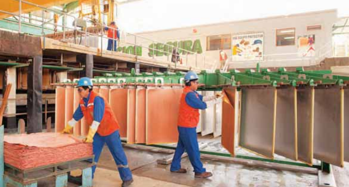
Production de cathode de cuivre dans nos opérations minières à Cerro Verde au Pérou
