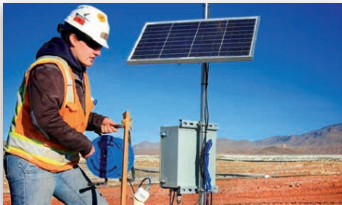
Karla Peabody, métallurgiste à l'exploitation de Safford en Arizona, maintient un piézomètre sur le remblai de lixiviation de la phase 1. Les piézomètres fournissent des données en temps réel du niveau de la solution aux métallurgistes qui surveillent l'état de la structure des remblais de lixiviation afin de garantir la production sûre du cuivre.
