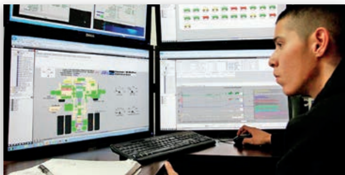
Le mécanicien de diagnostic de la mine de Tyrone, Royce Parra, surveille en temps réel le fonctionnement des équipements miniers lourds en utilisant la technologie Remote Access Monitoring Process (Système de surveillance et d'accès à distance - RAMP). La mise en œuvre du RAMP a permis d'améliorer la fiabilité de la flotte grâce à la détection et à la prévention précoce de tout dysfonctionnement des équipements, ainsi que la promotion des pratiques d'exploitation qui assurent une meilleure efficacité des équipements.
