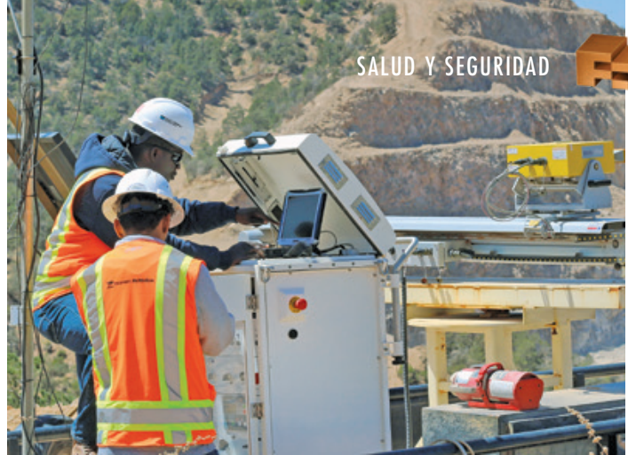
Ingenieros geomecánicos utilizan instrumentos tales como radar y GPS para detectar condiciones que pudieran llevar a una falla del talud del pozo. En la foto, los ingenieros Caesar Oppong y Enrique Silva calibran una unidad de radar que examina el movimiento del talud en las operaciones de Tyrone.
