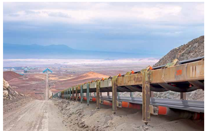
La energía gravitacional potencial asociada con el descenso de 470 metros de la correa transportadora de El Abra es mayor que la energía requerida para energizar la propia correa. Como resultado, durante su frenado se producen cinco megawatts de electricidad, los que se usan en la operación.
