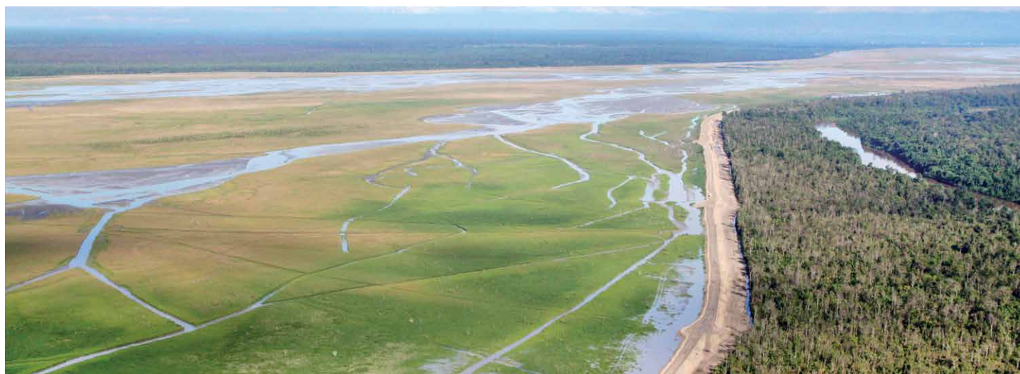
Operar el sistema controlado de manejo de relaves ribereños es un foco clave en PTFI. El área de depósito del dique (arriba se muestra un segmento de ejemplo) contiene la huella de relaves y sedimentos naturales siendo colonizada por especies de plantas acuáticas.
