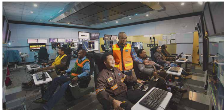
Operadores de PTFI pilotan de forma remota cargadores automatizados desde la instalación de control de minas subterráneas, manteniendo la seguridad del trabajador y aumentando la productividad.
